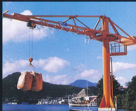
ジブクレーン
